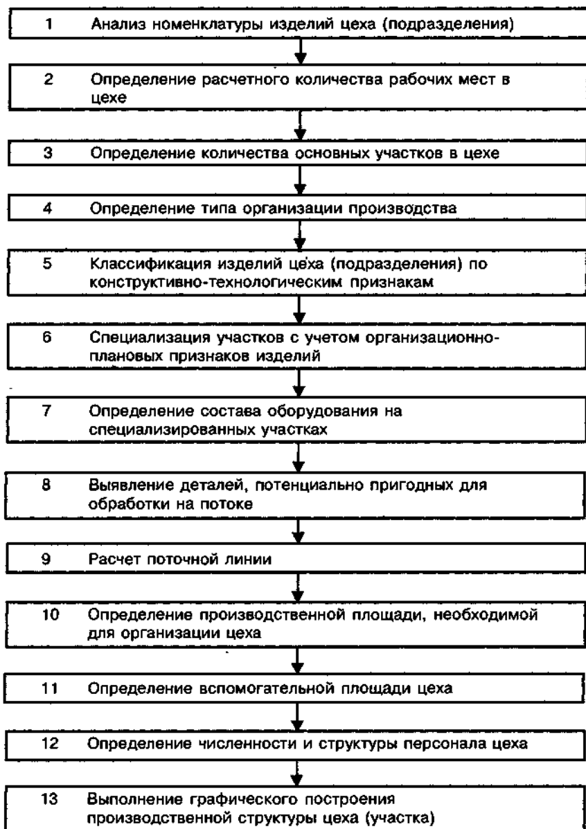
Рис. 5.4. Очередность этапов проектирования производственной системы
